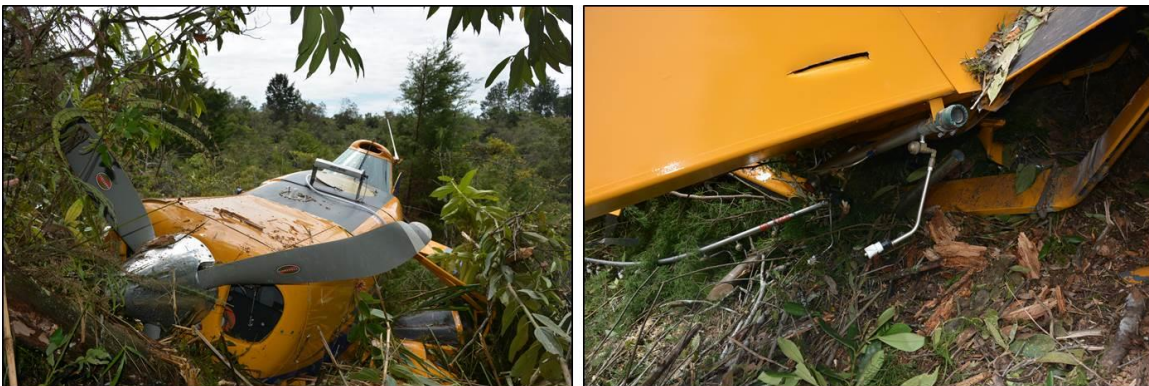
Fotografía No. 6 y No. 7 - Daños en las puntas de las palas de la hélice (Izq.) y sistema de aspersión (Der.)
