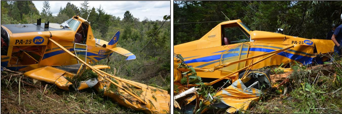
Fotografía No. 2 y No. 3 - Daños en el plano izquierdo (Izq.) y plano derecho (Der.)
