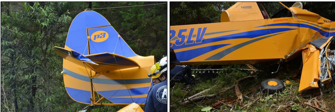
Fotografía No. 4 y No. 5 - Daños en la punta del estabilizador horizontal derecho (Izq.) y tren de aterrizaje (Der.)
